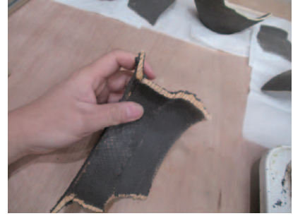
③欠失部の芯材作製
