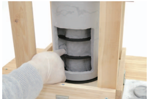
⑱接合 エポキシ樹脂 (バイサム) を隙間に補填
